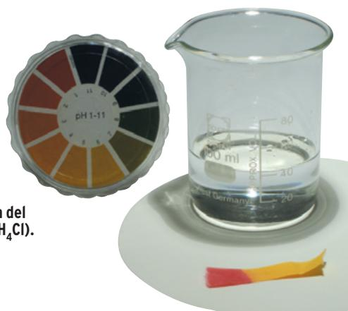
Fig. 4 Idrolisi acida del cloruro di ammonio ( $\text{NH}_4\text{Cl}$ ).
