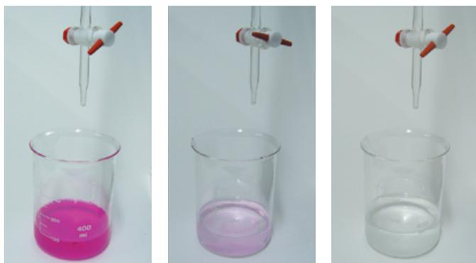
Fig. 7 Titolazione di una soluzione di idrossido di sodio con acido cloridrico a titolo noto (l'indicatore è la fenolftaleina).
