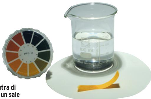
Fig. 2 Soluzione neutra di cloruro di sodio ( $\text{NaCl}$ ): un sale che non si idrolizza.
